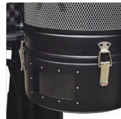
A hulladéktartály telítettségének ellenőrzése
