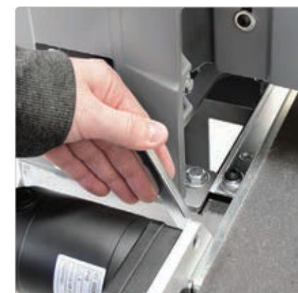
Kar az asztal emeléséhez széles munkadarabok csiszolásához
